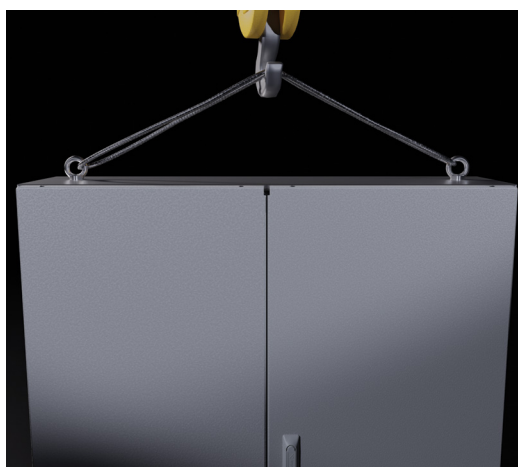
Угловая нагрузочная способность Для каждого рым-болта: 45 градусов: F = 2400 \text{ Н} 60 градусов: F = 3200 \text{ Н}
