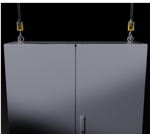
Вертикальная нагрузочная способность Для каждого рым-болта: F = 2000 \text{ Н}
